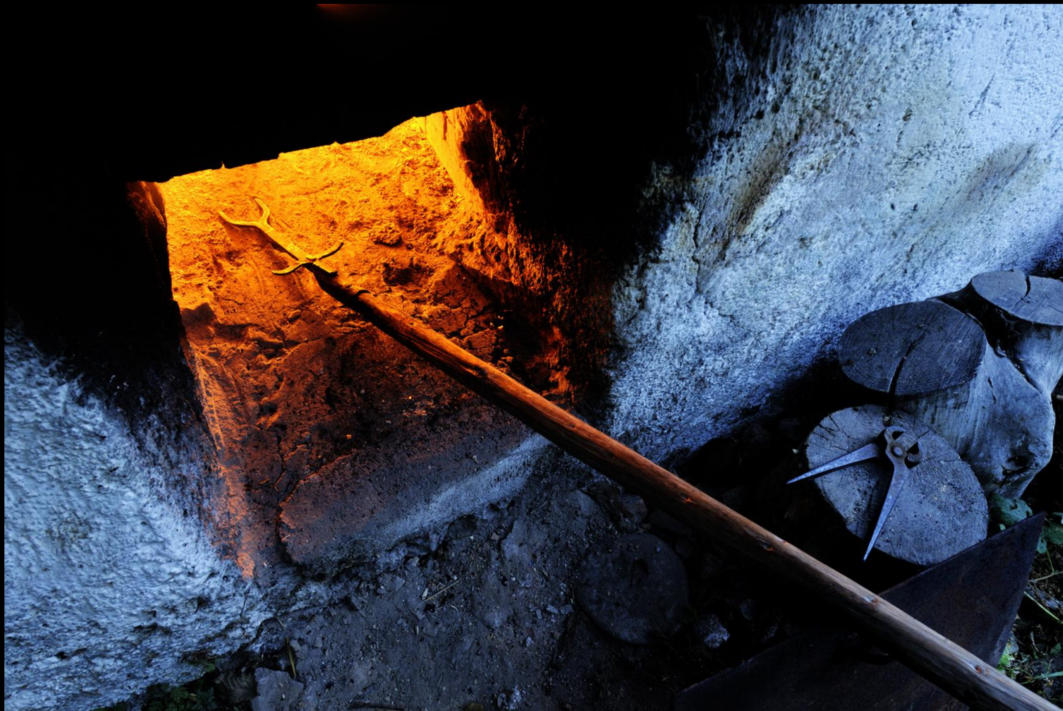
Werkzeug zum Verteilen der Holzscheite in der Brennkammer.
